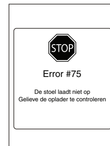
Figuur 15. Q-Logic 3 indicator voor het opladen van de accu
